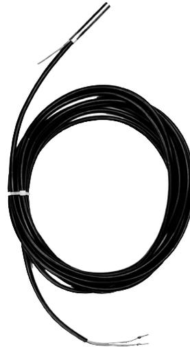
La sonde de température KVT 20 est une sonde à plongeur avec câble raccordé et sert à mesurer la température de la chaudière et de l'eau chaude sanitaire. Elle est logée dans un doigt de gant approprié dans la chaudière avec les éléments de sonde de limites de températures de sécurité (STB), de régulation de température de chaudière (KTR) et de l'affichage de température de chaudière (KTA). Le tendeur dans la sonde veille à la compression nécessaire.
